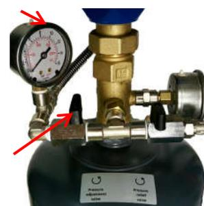
Vanne de réglage de la pression de nettoyage
